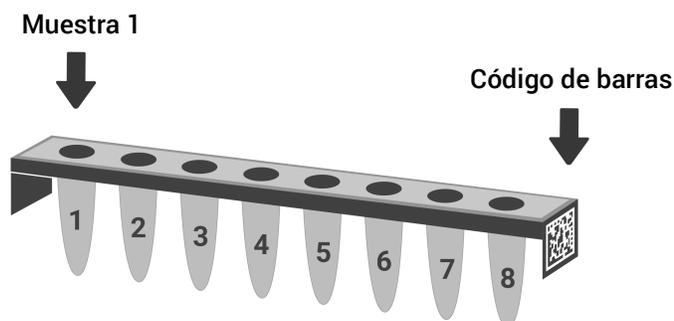
**Figura 18** Orientación de las Magnis Sample Input Strips
