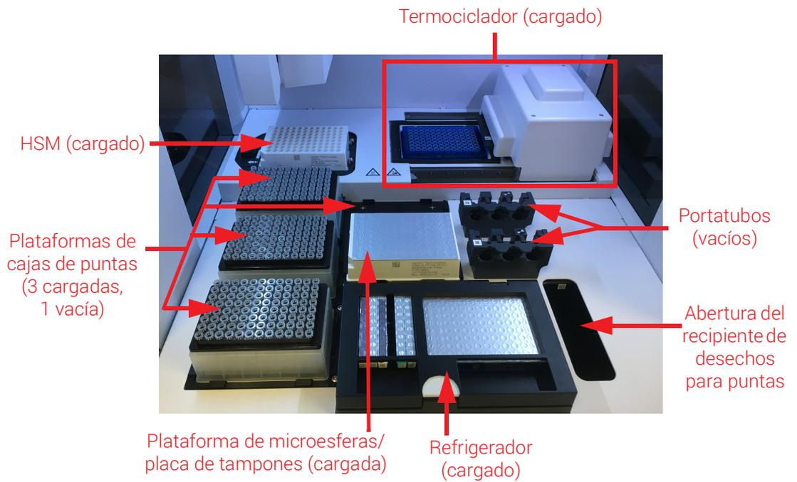
**Figura 4** Tablero del instrumento
