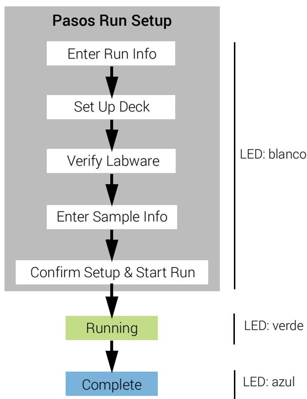
**Figura 19** Flujo de trabajo del protocolo, con el color correspondiente de los pilotos indicadores de estado
