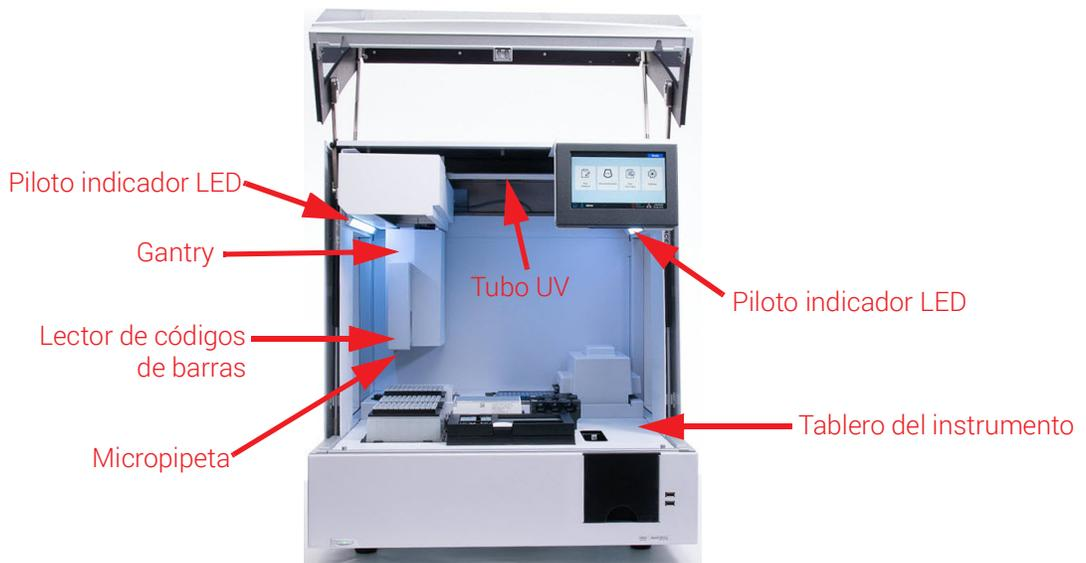
**Figura 3** Interior del instrumento
